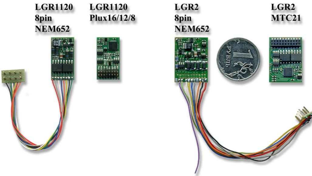
Локомотивный декодер «LGR1120» предназначен для инсталляции в локомотивы масштаба H0, TT, N.
